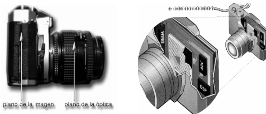
Fig. 3 Plano de la óptica, de la imagen y sensor CCD.
